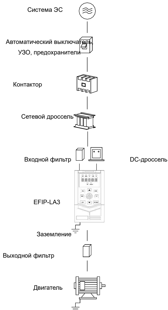
Подключение дополнительного оборудования
