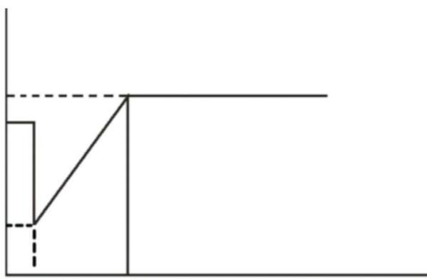
Рисунок 5–4 Пуск со скачком и линейным нарастанием напряжения
