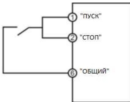
Для запуска двигателя выключатель замыкается, для останова – размыкается.
