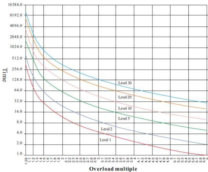
Рисунок 5–6 Кривые характеристики защиты от перегрузки
