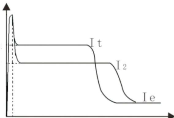
Рисунок 5-3 Пуск со скачком и ограничением тока
