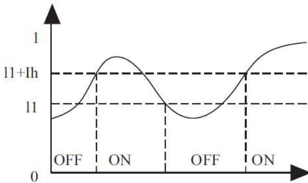
Рисунок 5-8 Работа в режиме «ток выше уставки», тип 2
