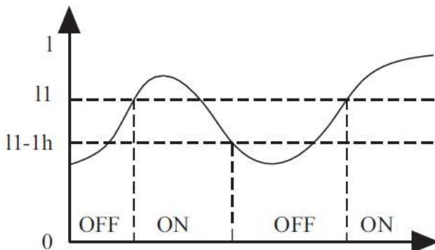
Рисунок 5-7 Работа в режиме «ток выше уставки», тип 1
