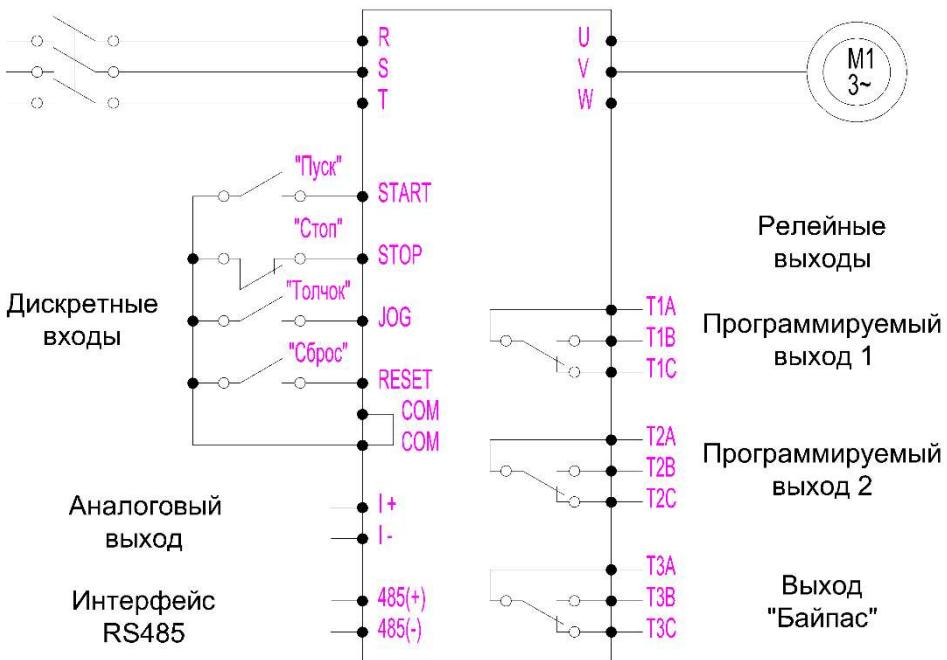
Клеммы R, S, T – ввод питания от сети, клеммы U, V, W – подключение двигателя. Рекомендуется применение автоматического выключателя в качестве устройства защиты на вводе питания.
